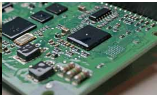
A védőbevonattal ellátott vezérlőkártyák szélsőséges környezeti feltételeknek is megfelelnek.
