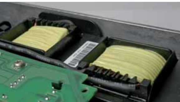
A közbensőkori, egyenáramú fajtótekercecsek csökkentik a felharmonikus tartalmat és védik a frekvenciaváltót.
