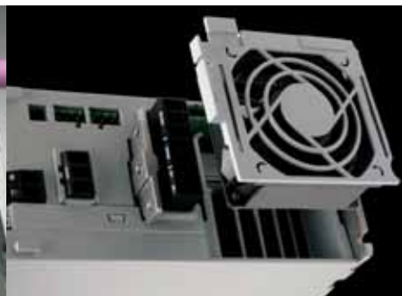
A ventilátor könnyen eltávolítható a hűtőbordák tisztításához.
